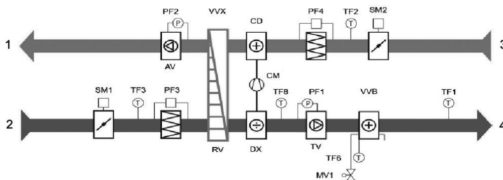
Если в системе охлаждения сработали реле k4.6 или k4.7, но компрессоры не запускаются, проверьте кабели и соединение защелкивающихся разъемов между секциями агрегата. Блок управления оборудованием системы охлаждения находится в блоке охлаждения. Убедитесь в том, что рабочее/сигнальное реле 7k02 срабатывает. Оно должно срабатывать при включении напряжения. Если реле не сработало, неисправно одно из следующих устройств:
