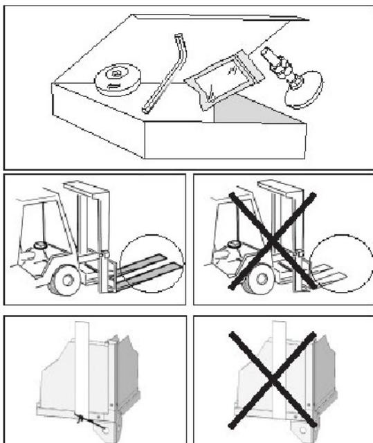
При подъеме с помощью вилочного погрузчика или домкрата для поддонов вилы погрузчика должны располагаться под днищем по всей его длине, в противном случае возможно повреждение днища. При использовании крана стропы необходимо крепить к опорам или поддону. Важно, чтобы стропы не соскользнули во время подъема.
