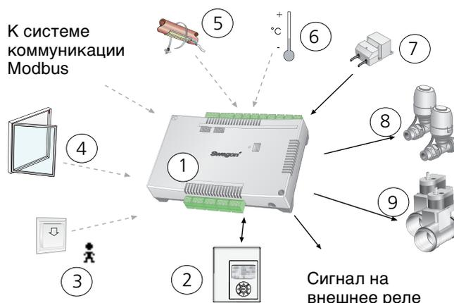
Рис. 2. CONDUCTOR W3: комплект компонентов
