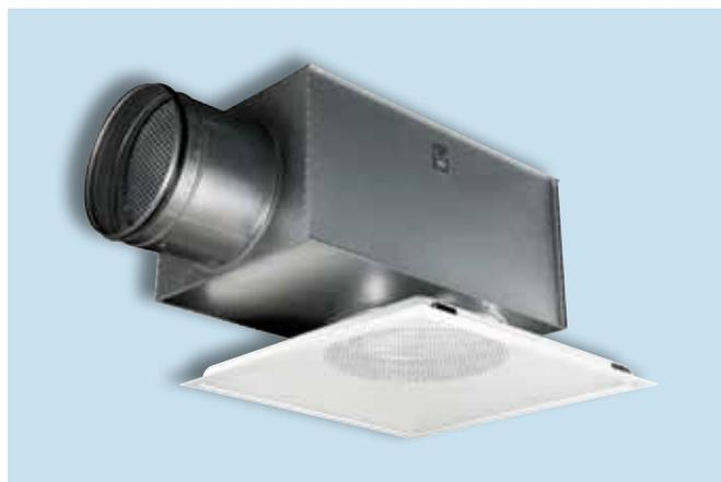
Манжета/штуцер корпуса диффузора прикручивается к воздуховоду либо крепится глухими заклепками. При установке диффузора в гипсовом потолке, штуцер прикручивается винтами сбоку или сверху.
