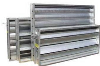
Воздушные клапаны выполняют в центральном кондиционере следующие функции: регулирование и перекрытие воздушного потока, балансировка потерь давления в секции фильтра из-за его загрязнения, защита системы от замерзания, перекрытие подачи воздушного потока в воздуховод при опасности возникновения пожара.
