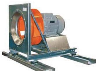
Центробежные вентиляторы с загнутыми вперед или назад лопатками статически и динамически сбалансированы в соответствии со стандартом VDI 2060. В качестве опции предлагаются безулиточные вентиляторы со свободно расположенным рабочим колесом. Привод вентиляторов стандартно обеспечивается шкивно-ременной передачей. Безулиточные вентиляторы имеют непосредственный привод от электродвигателя.
