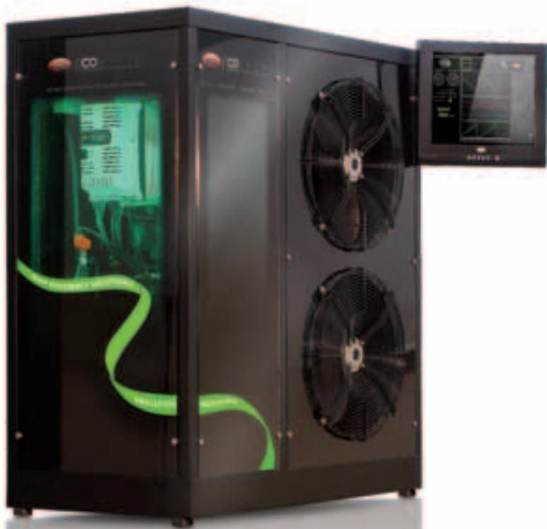
Die Demo-Einheit ermöglicht die Performanceanalyse eines Scroll-Verdichters mit gebürstetem Dauermagnet-Motor und Sensorless-Technologie, der mittels CAREL-Inverter Power+ drehzahlgesteuert wird. Durch die Verdichterfrequenzregelung kann die Erhöhung der Leistungszahl einer hypothetischen Wärmepumpe mit analoger Regelungstechnik geschätzt werden. Außerdem zeigt die Demo-Einheit den optimierten Betrieb des CAREL-Systems auf, bestehend aus:
