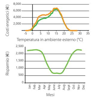
\*Misurazioni svolte in una centrale telefonica dove sono stati collocati per il condizionamento dell'aria 6 chiller R22 bi-circuito con capacità massima 900 kW
