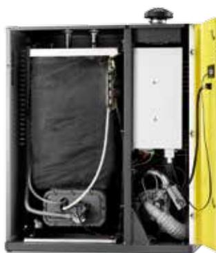
gaSteam ist mit Unterdruck-Pre-Mix-Gasbrenner in hermetischer Kammer und weitem Modulationsbereich ausgestattet. Sein Wärmetauscher aus Edelstahl von intelligenter Geometrie garantiert die heute höchste erzielbare **Energieeffizienz (bis 96 %)**. Das redundante Fühler- und Steuerungssystem hat die **Zulassung nach den internationalen Sicherheitsvorschriften erlangt**.
