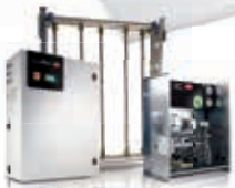
Optimist/KEC Effiziente Kühlung der Luft durch Nutzung der Verdunstung von feinem Wassernebel: 100 kg/h verdunstendes Wasser absorbieren 69 kW Wärme der Luft bei einem Energieverbrauch von weniger als 1 kW.
