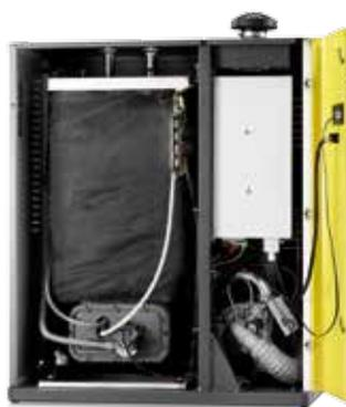
El gaSteam está dotado de quemador de gas de tipo pre-mix a presión negativa en cámara estanca con elevado campo de modulación y dispone de un intercambiador de calor de acero inoxidable de sofisticada geometría que garantiza la **máxima eficiencia energética** disponible hoy en día en el mercado (hasta el 96%). El sistema de sensores y controles redundante ha permitido la **homologación según las principales normas de seguridad internacionales**.
