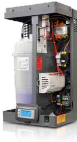
El humiSteam produce vapor de agua potable de conductividad comprendida entre 75 y 1250  $\mu\text{S}/\text{cm}$  y **se adapta automáticamente a las características del agua** optimizando la duración del funcionamiento sin mantenimiento. El amplio arco de modulación (del 20% al 100%) y el sofisticado control electrónico permiten una regulación precisa de la humedad ambiental; la sonda de límite evita la condensación en conducto en cualquier situación.
