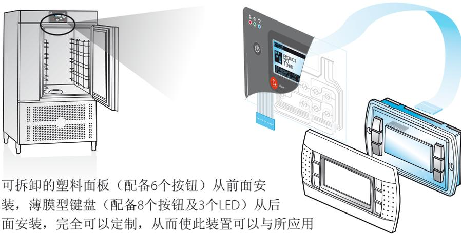
可拆卸的塑料面板（配备6个按钮）从前面安装，薄膜型键盘（配备8个按钮及3个LED）从后面安装，完全可以定制，从而使此装置可以与所应用设备的设计达到完美的统一。
