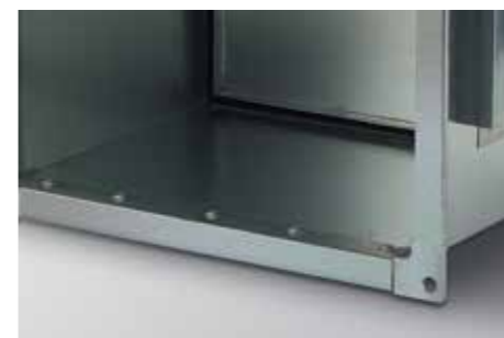
Согласно новым требованиям пожарной безопасности СП 7.13130.2013, толщина применяемой стали не должна быть менее 0,8 мм. В клапанах Ballu применяется сталь 1 мм.
